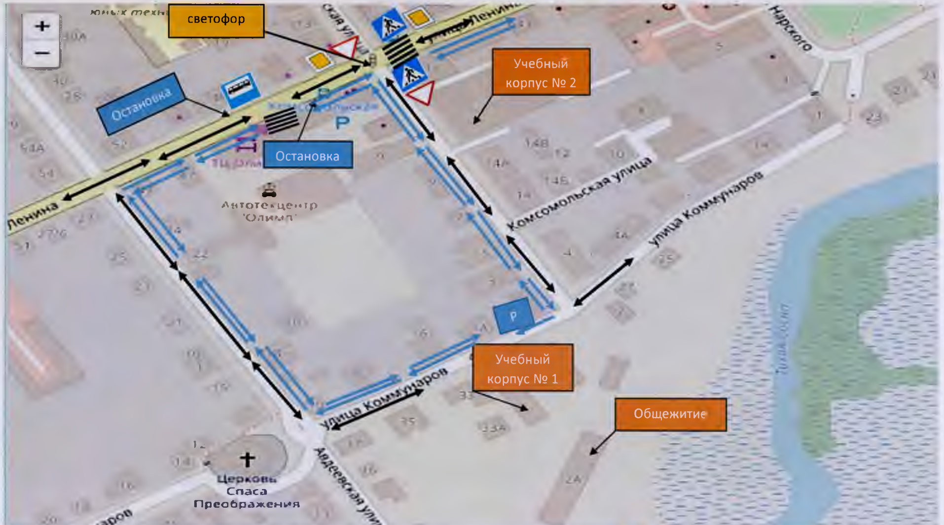
1.2 Схема организации дорожного движения в непосредственной близости от образовательного учреждения с размещением соответствующих технических средств, маршруты движения обучающихся и расположения мест автотранспорта.
